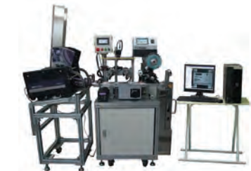
NaviCa-Lite-MF 標準本体サイズ:W1,800mm、D750mm、H1,800mm 対象ワークサイズ:85.6mm×54mm
