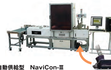
高速自動供給型 NaviCon-III 標準本体サイズ:W2,000mm、D700mm、H1,410mm、重さ 約250kg 対象ワークサイズ:最小40mm×90mm、最大180mm×250mm
