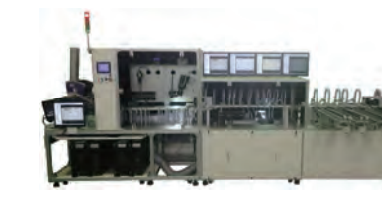
NaviCa-III 標準本体サイズ:W4,425mm、D1,985mm、H1,740mm 対象ワークサイズ:85.6mm×54mm
