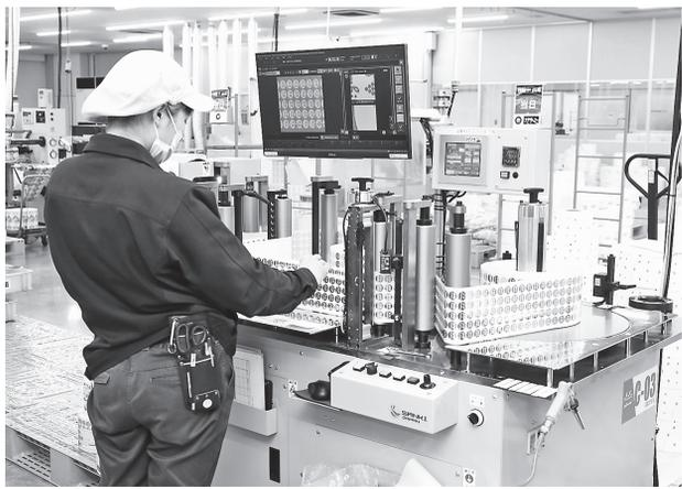
シリウスビジョン製の検査機を運用。4台中3台が同社製のもの設備し、自社が定める品質基準の維持に活用している
