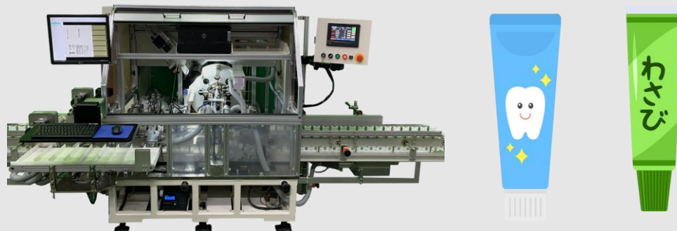
各種チューブ容器の印刷および外観を150本/分で高速検査
