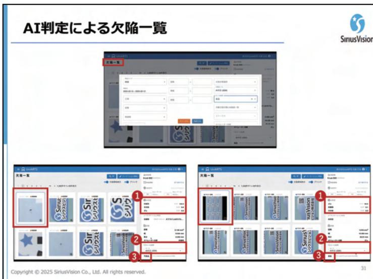
上図：AI判定による欠陥データを様々なフィルターで絞り込んで「欠陥一覧」として表示させることが可能で、AI判定精度のモニタリングも容易である。
