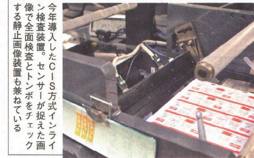
今年導入したCISS方式インライン検査装置。センサーが捉えた画像で全面検査とトンボをチェックする静止画像装置も兼ねている
